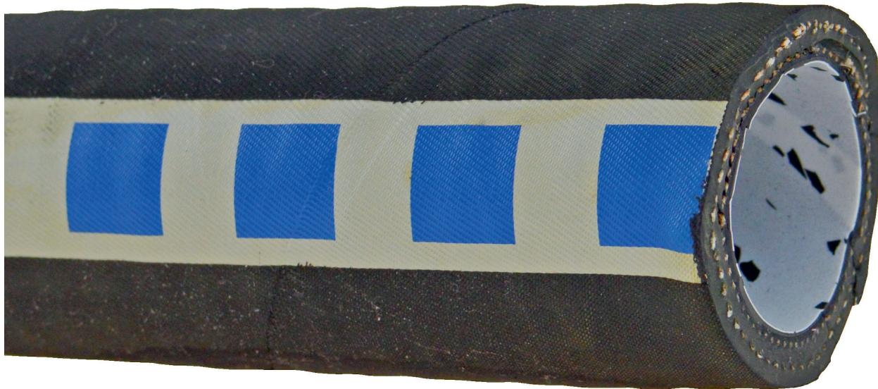
Robuster, flexibler Gummi-Saug- und Druckschlauch mit Gewebeeinlage und Stahlspirale geeignet zum Fördern fast aller Chemikalien, Lösemittel sowie heißer Medien und Lebensmittel, zertifiziert für die Verwendung in ATEX Umgebung.
