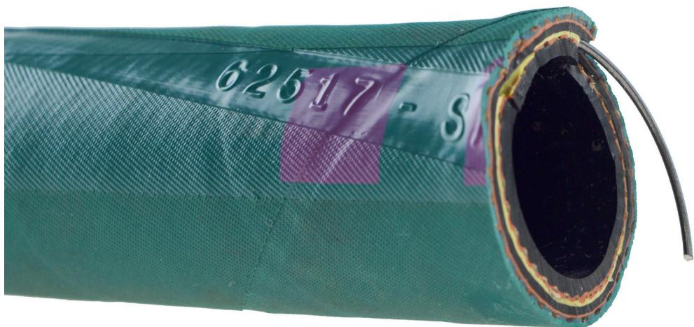
Robuste, strapazierfähige, flexible Gummispiralsaug- und Druckschläuche, dorngewickelt, antistatisch durch eine Kupferlitze. Ausgelegt für ein volles Vakuum.
