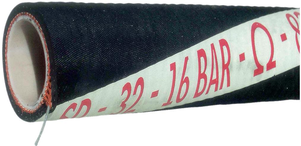
Dorngewickelter Gummi-Saug- und Druckschlauch mit FEP Seele nach EN 12115/11, FDA. Seele nach USP Klasse VI und FDA Titel 21 für Lebensmittel geeignet. Geeignet zum Durchleiten fast aller Chemikalien und Lösungsmittel sowie heißer Medien und Lebensmittel.
