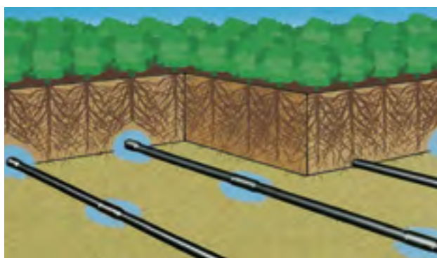
Installationsschema für die unterirdische Installation des ROOTGUARD™ Multibar®
