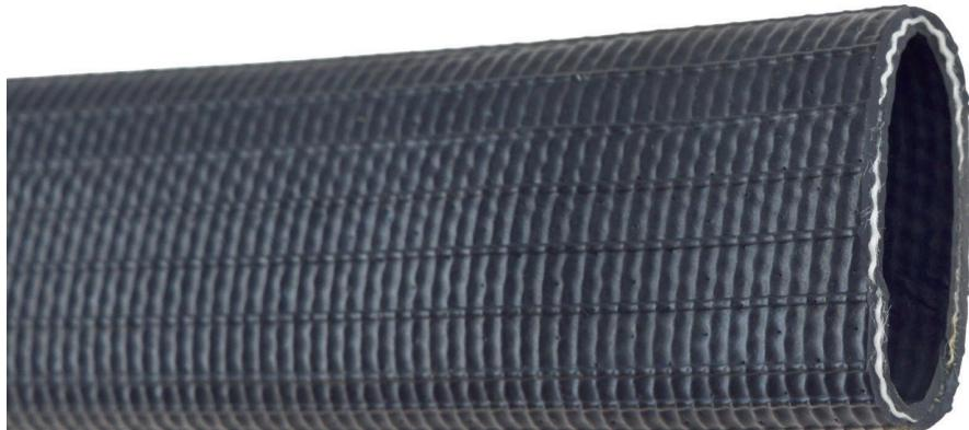
Vielseitig einsetzbarer Gummiflachschlauch mit verstärkten, rundgewebten Polyesterreinlagen, innen und außen hochwertiger, synthetischer Gummi, durchvulkanisiert, innen glatt, außen feine Längsriefen, schwarz, geeignet für Luft und Flüssigkeit. Er ist beständig gegen Luft, Frischwasser, Seewasser, Schmutzwasser, Gülle, Ölspuren, Chemikalien und Witterungs- und Ozoneinflüssen.
