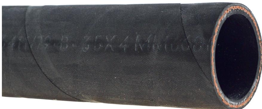
Flexibler, dorngewickelter Gummidruckschlauch, Heißwasserschlauch mit stoffgemusterter Decke - nach DIN 73411-79. Geeignet zum Fördern von Heißwasser und Kühlmittel auf Glykolbasis.
